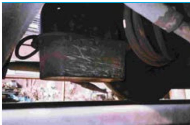
Captador de FAP al bogi d'un tren.
