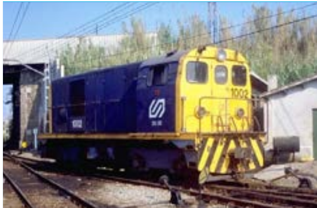
Locomotora dièsel amb transmissió elèctrica.
