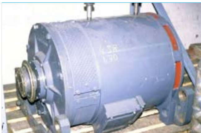
Motor elèctric de tracció.
