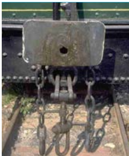
Enganxall manual de topall i brida.
