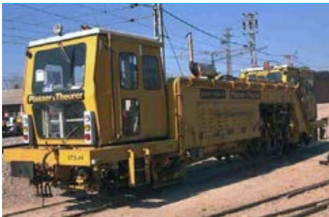
Batonadora de balast.
