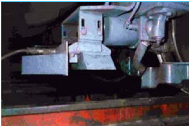
Antena de l'ATP instal·lada al bogi.
