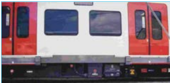
Equips de potència situats sota la caixa del tren.
