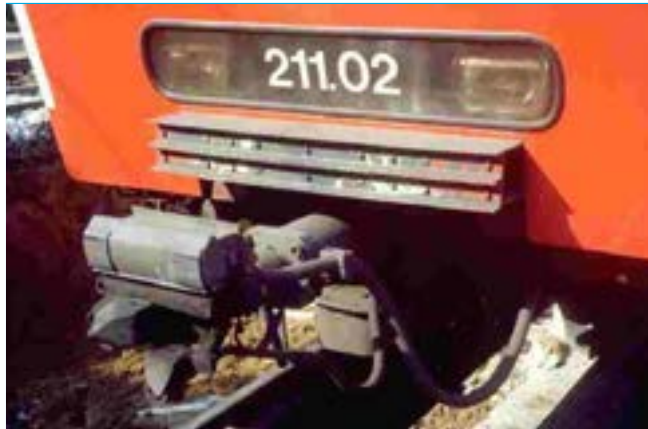
Unitat de tren dotada d'enganxall automàtic BSI.
