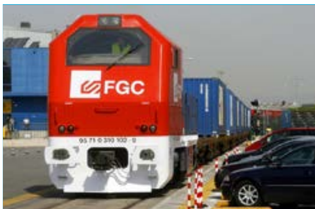
Locomotora dièsel per a trens de mercaderies.
