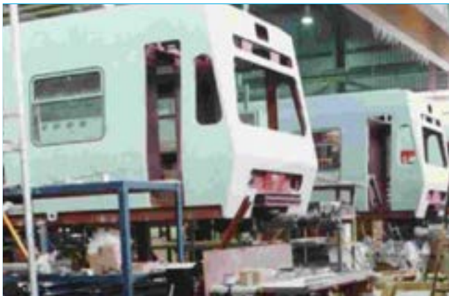
Bastidor autoportant d'unitat de tren.
