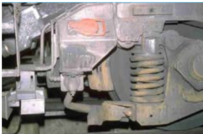
Suspensió primària d'una unitat de tren.
