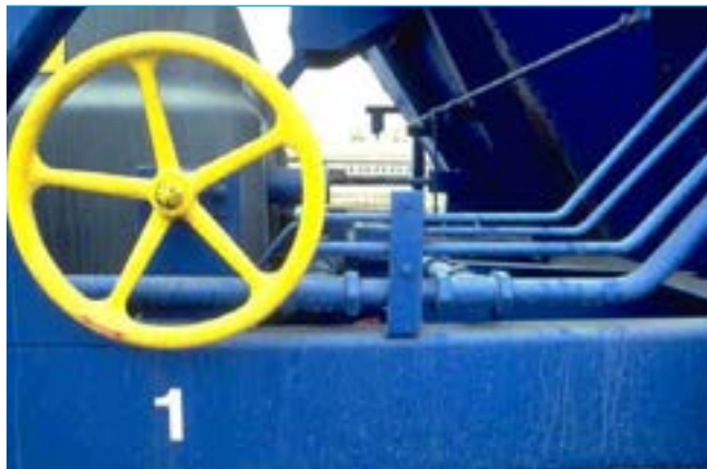
Volant de fre d'estacionament manual.
